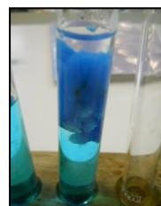
On ajoute quelques gouttes de soude (hydroxyde de sodium) contenant des ions hydroxyde  $HO^-$  à une solution contenant des ions cuivre II  $Cu^{2+}$ . Un précipité bleu d'hydroxyde de cuivre II  $Cu(OH)_2$  apparaît.
