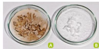
FIG. 7 Cristaux d'acide benzoïque avant A et après B recrystallisation.
