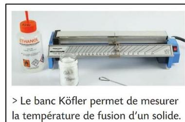
> Le banc Köfeler permet de mesurer la température de fusion d'un solide.
