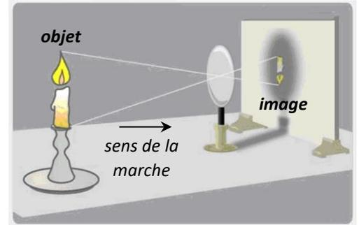
On se limite à la construction de l'image d'un objet  $AB$  perpendiculaire à l'axe optique (comme la bougie). L'image  $A'B'$  est elle aussi perpendiculaire à l'axe optique.
