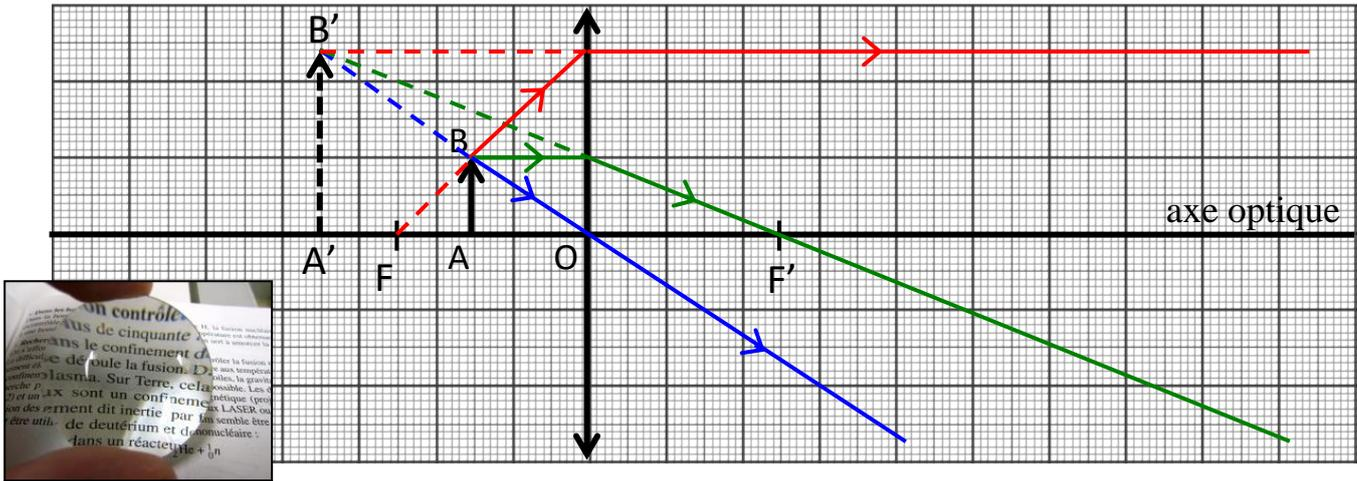
Les rayons émergents se coupent si on les prolonge du côté de l'objet AB. Ils permettent de tracer l'image A'B'.
